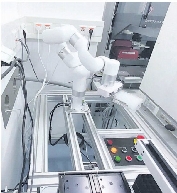
In Großlabors werden Roboterarme eingesetzt, die schnell und präzise pipettieren können. Die stationären Einheiten sollen bald mit frei beweglichen Robotern ergänzt werden.
